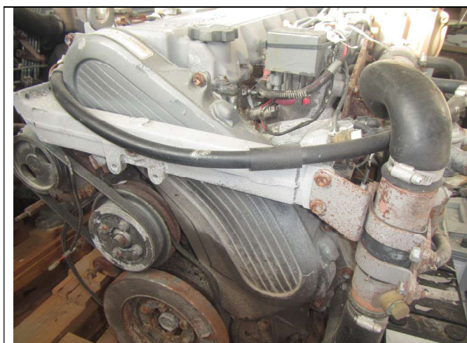
Motori nisu zaštićeni i nagriženi su korozijom
