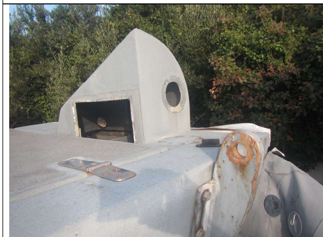
Vjetrolovke strojarnice su devastirane
