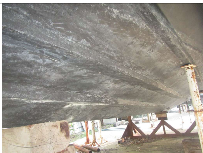
Potrebno je obnoviti anti-osmoznu i anti-vegetativnu zaštitu
